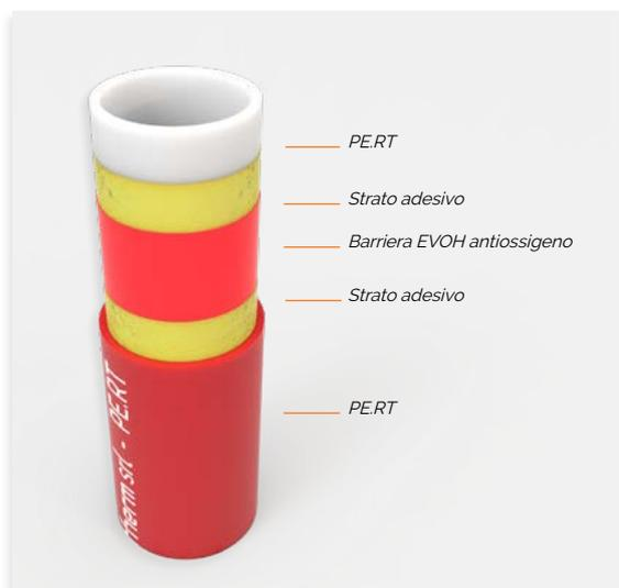
La tubazione **PE.RT** proposta da GEAttherm è composta da 5 strati accoppiati per garantire il corretto ed **efficiente** scambio termico con il massetto.
